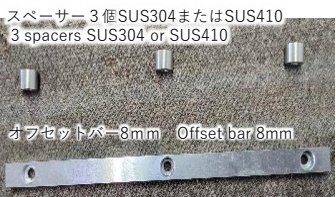
クランプスペースが2mmに Clamp space is 2mm
