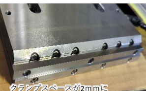
クランプスペースが2mmに Clamp space is 2mm
